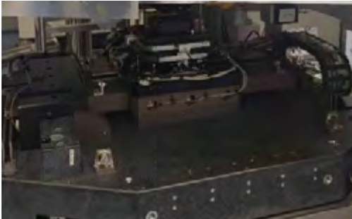
图3 测试运动台结构实物图
