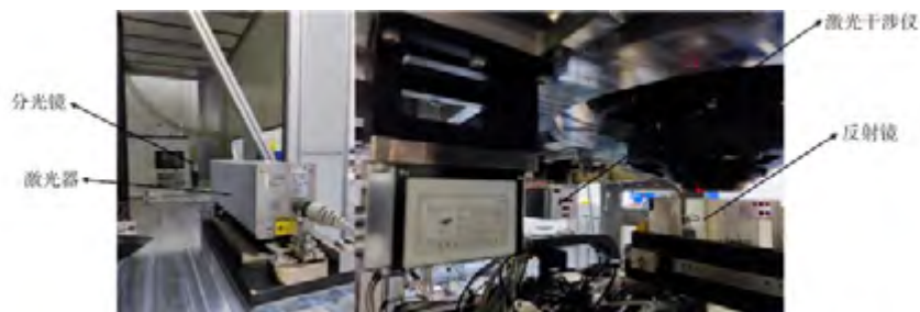
图6 双频激光干涉仪实物图
