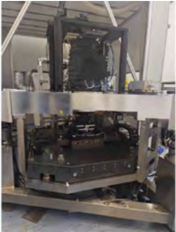
图5 投影物镜像质检测台内部结构实物图
