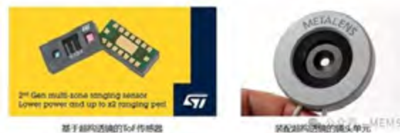
Metalenz 设计 + 意法半导体制造的 ToF 传感器 (左)；佳能展示的装配超构透镜的镜头单元 (右)
