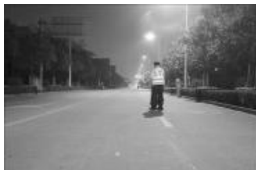
图2 路灯高10米，路宽12米，双侧布灯，测试时单侧路灯
