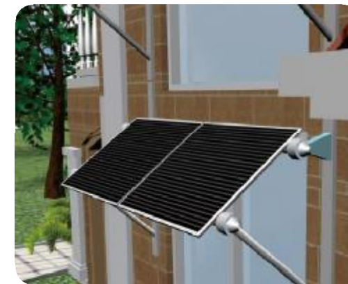
图3 非晶硅薄膜电池组件遮阳系统
