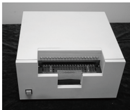
图7、LED封装质量非接触检测实际样机
