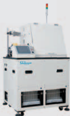
200系列 SMD LED高速测试分类机 Max. 0.15 秒/个，UPH约为 24 K/H
