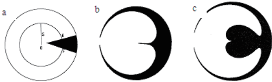
图二十：镀制抛物面用的非球面挡板
