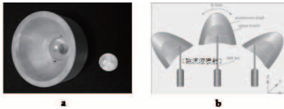
图十：(a) 光学元件实物照片, (b) 抛光过程工件的运动情况
