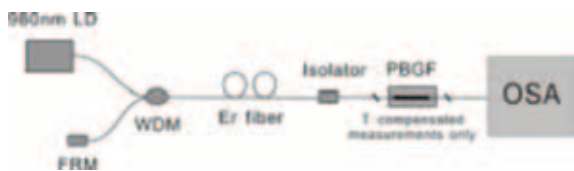
图3 集成全固光子带隙光纤双程正向掺Er超辐射光纤光源
