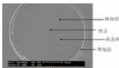
图6 掺Yb3+单偏振大模场面积双包层光子晶体光纤端面图
