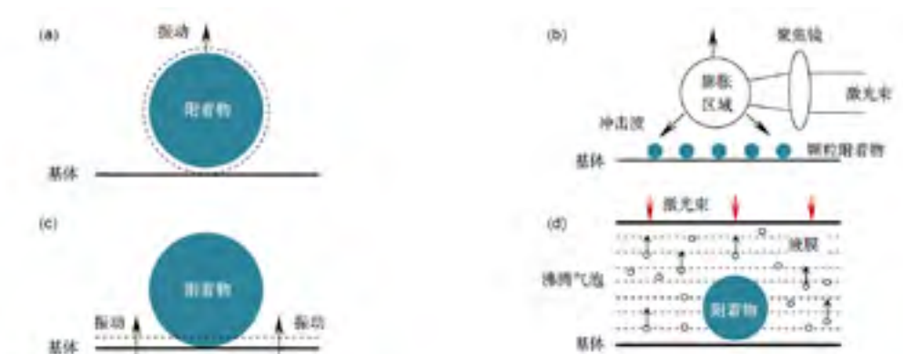
图 3 激光清洗不同作用对象示意图。(a) 附着物；(b) 附着物层内气体；(c) 基体；(d) 预覆液膜
