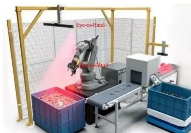
图 3 机器人协同视觉系统原理图
