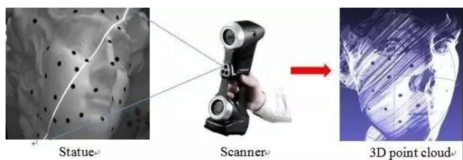
图 4 线结构光扫描三维点云生成示意图
