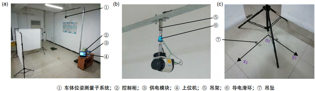
图 6 实验室搭建测量与标定系统
