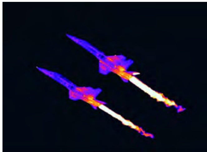
美国海军蓝色天使表演队的F/A-18在中低波长红外中的图像,可以注意到发动机羽流的辐射强度明显较高。
