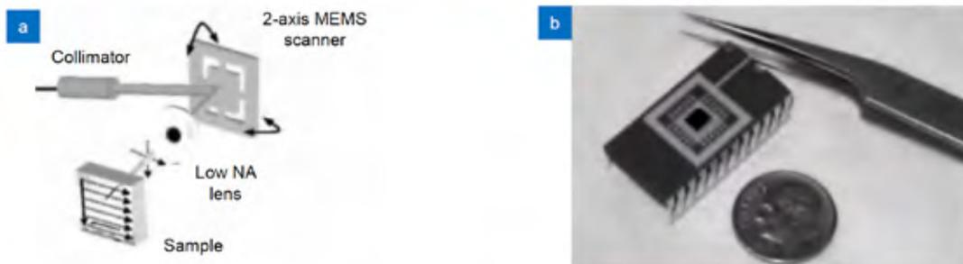
图 3 二维 MEMS 扫描镜<sup>[50]</sup>。(a) 扫描示意图;(b) 封装后的 MEMS 扫描镜
