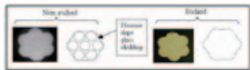
图7 腐蚀和无腐蚀熔融束端面的实物图和示意图
