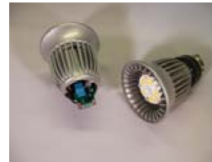
图 1 灯泡替换使电源空间变得极小
