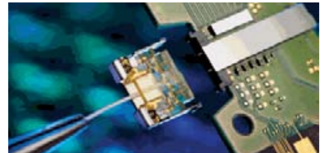
图 3: 英特尔的 50Gbit/s 硅光子发射器和光纤连接器。右边的宽金属条纹是发射模块，其是电路板一个倒装芯片。突出的金属引脚对准小插件模块，耦合光纤在左下方延伸。
