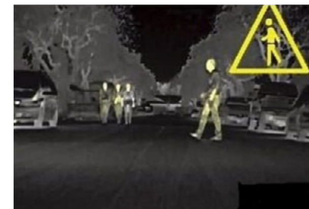
图 2：当在夜间检测到一名男子在车前横穿马路时，宝马 BMW-7 系列汽车的远红外夜视系统向驾驶员发出了警报在行车速度较慢、人流较多的城市路段，该系统只对道路上近距离内的较小范围进行监测，以避免出现过多的警报；而在行车速度较高、人流稀少的乡村路段，该系统监控的道路范围则会相应地扩大。为了对监控范围做出及时、相应的调整，Autoliv 公司的夜视系统不断地从周围环境中收集夜视视频图像，并用一套先进的软件算法对超过 5000 多万个“影像片段”进行检测，并依此向驾驶员发出相应的警报信号。
