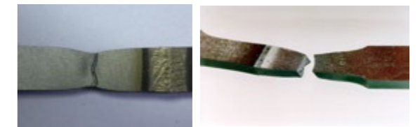
▲ 图 5 激光焊接后的焊缝强度测试图
