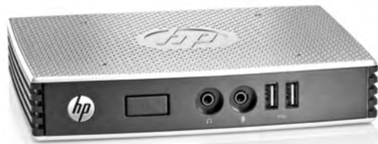
▲ Zero-Client 产品可利用单一线缆传输达到仿真常规计算机的所有应用资源，但连接线缆的传输效能将左右应用服务的体验，光纤化发展有助于推广 Thin Client 瘦身型计算机应用需求。HP
