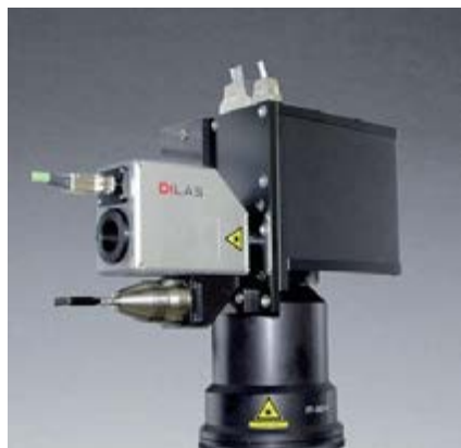
图 4: 扫描振镜 - 组合了高温计的优点, 实现快速光束偏转的在线加工控制。高温计测量的波长范围在 1800 至 2100nm 之间, 所以必须根据情况调整光学聚集系统。这一光学系统也保证了高温计点与激光聚焦重叠。
