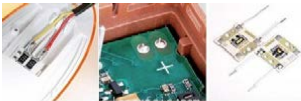
a) 温度敏感环境 b) 不良接触 c) 敏感 LED 设备 图 1: 常见选择性激光焊接应用案例。
