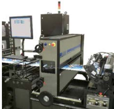
图 2 LaserSharp PL40 激光划线系统集成到装袋生产线中。
