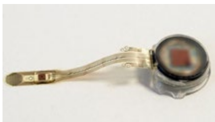
IRIS 植入组件：电极位于软性电极箔片顶端，并由封装的 ASIC 进行控制
