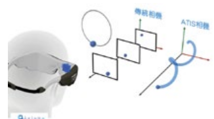
传统相机的数据密集型讯框获取 (左), 以及由 ATIS 传感器执行视觉动态的连续时间获取 (右)
