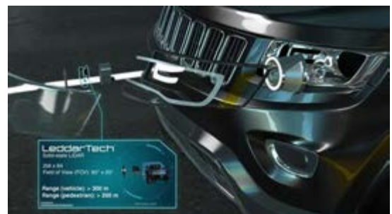
集成在汽车前大灯中的 LeddarTech 固态 LiDAR，视场角 60° x 20°，探测距离 300m(汽车)、200m(行人)
