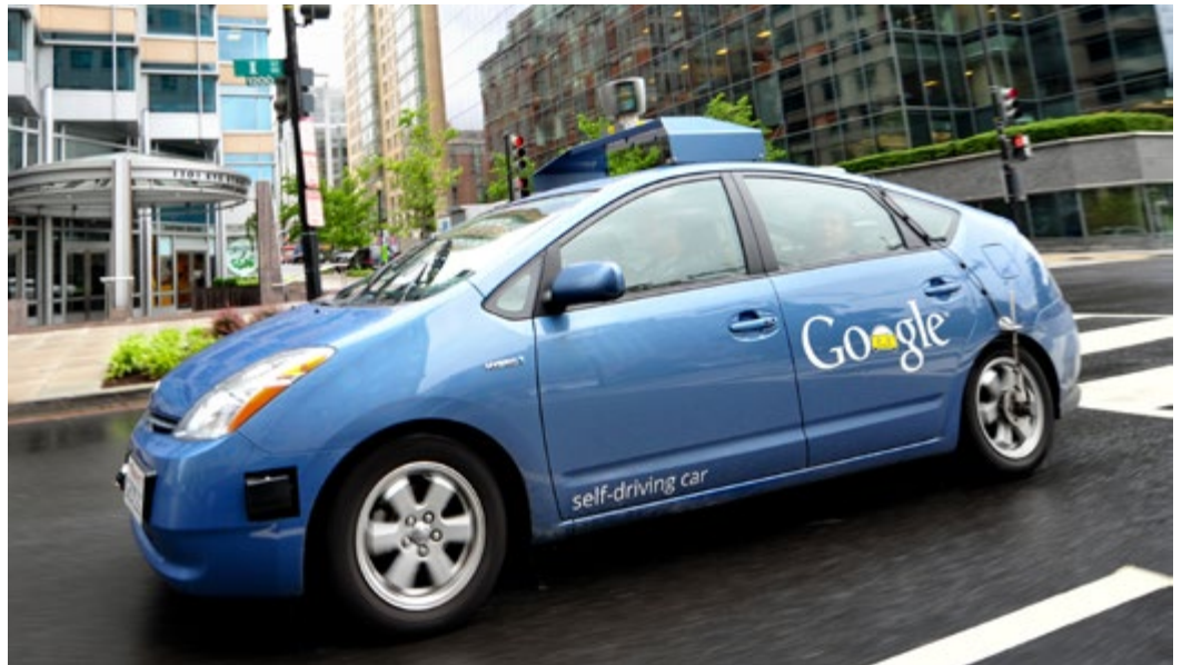
右图为谷歌早期的自动驾驶原型车。车顶有一个巨大的旋转式LiDAR传感器，前翼板上有个黑色的雷达（共4个），后轮上安装有“车轮编码器”，车内还有视频摄像头。这款原型车装配的各类传感器总价高达15万美元
